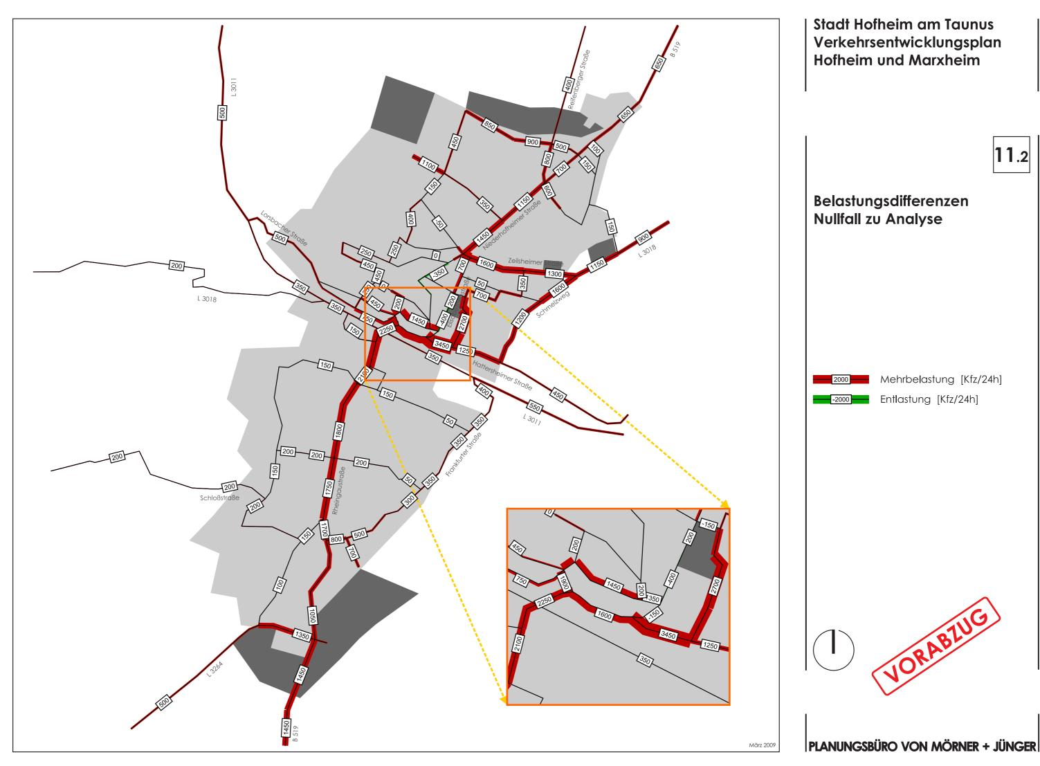
Belastungsdifferenzen Nullfall zu Analyse Mehrbelastung [Kfz/24h] Entlastung [Kfz/24h]
